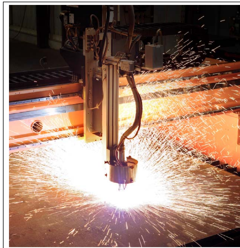
Plasma-Brennschneidanlage mit bis zu 30.000 Grad Brenntemperatur Foto: Ancofer
