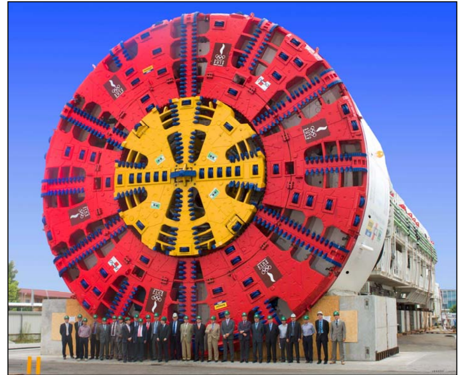
Mit 15,20 m Durchmesser einer der größten Tunnelbohrer der Welt/Herrenknecht AG
